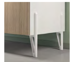
FAIRY Plus: pieds en alu à forme creuse H146 mm avec profil décoratif externe. Vérins de réglage Ø18 mm avec réglage 0-10 mm. Pas possible avec armoires avec côtés de finition.
